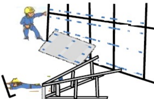
脚立からの墜落・転落
