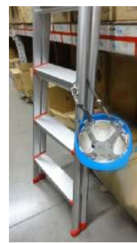
No.9脚立をより安全な手すり付のものに変更。また、保護帽を使うよう脚立に取り付けている。 ジョイフル本田
