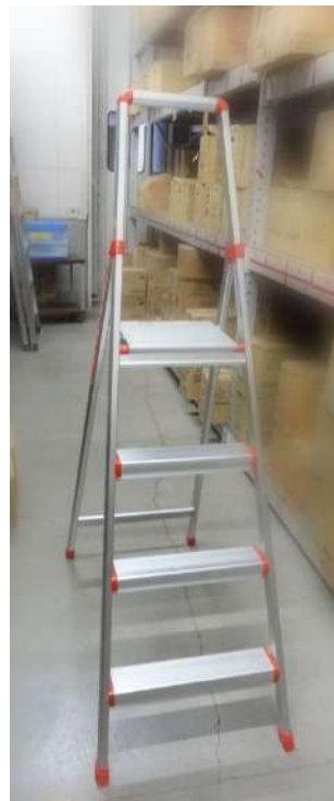
No.9脚立をより安全な手すり付のものに変更。また、保護帽を使うよう脚立に取り付けている。 ジョイフル本田
