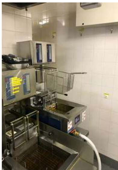
(改善後：自動投入、自動油交換)
